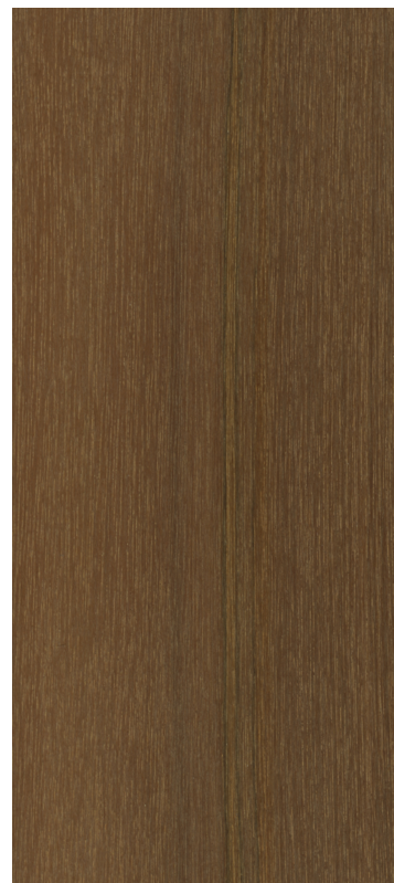
Débit sur faux quartier
